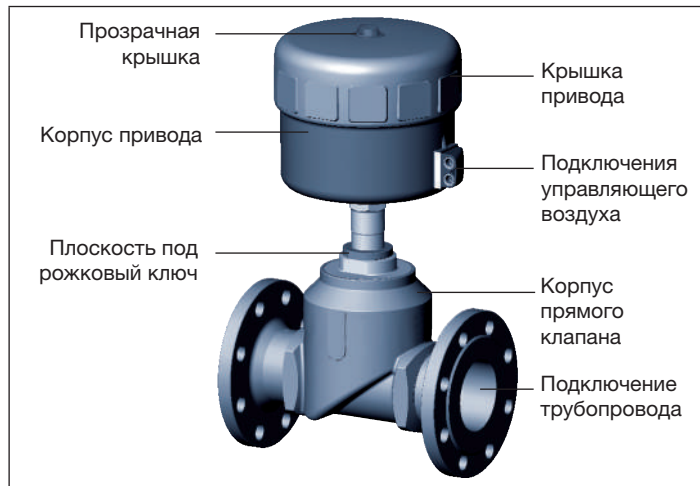
Рис. 1. Прямой клапан типа 2012, конструкция и описание
